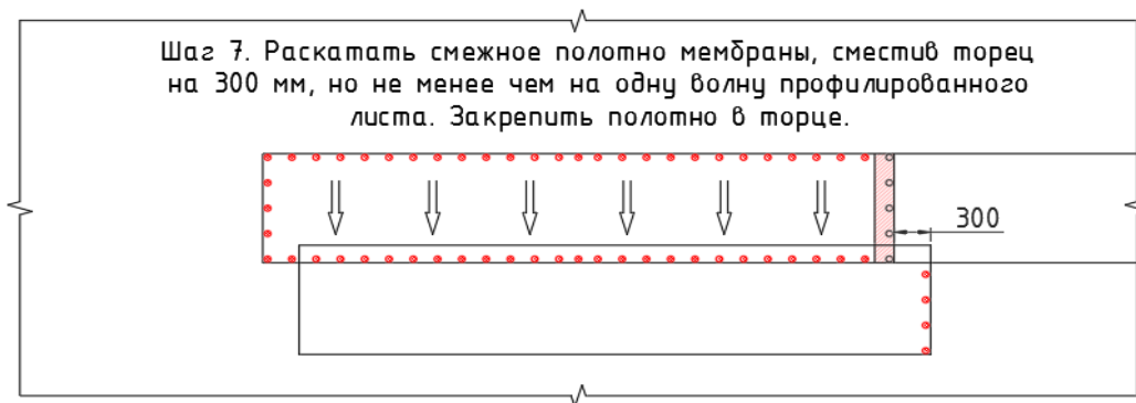
Рис. 5.19 Порядок укладки полимерных мембран. Шаг 7.
