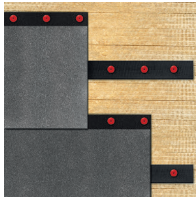
Рис. 7.45. Крепление полосы при устройстве однослойной кровли
