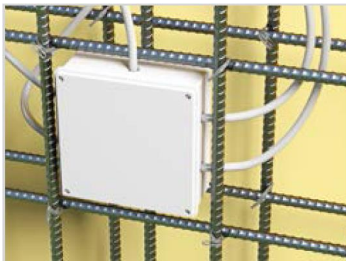
Рисунок 13.10 – Ревизионный короб с инъекционными трубками на стене тоннеля.
