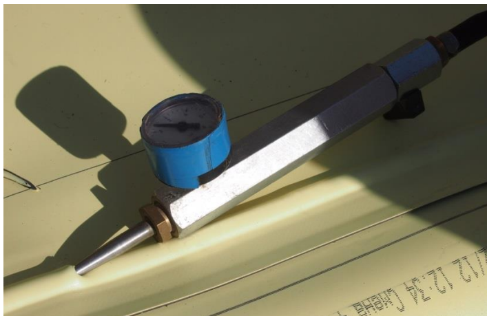
Рисунок 14.2 – Проверка герметичности двойного шва избыточным давлением воздуха.
