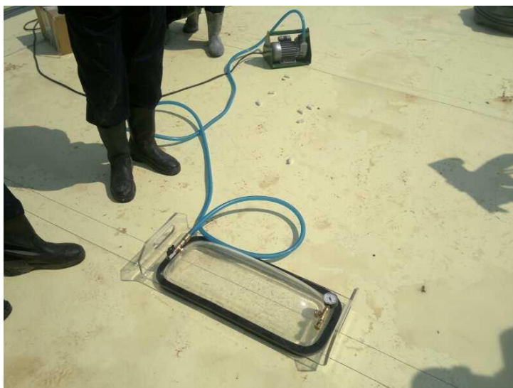
Рисунок 14.3 – Проверка герметичности швов с помощью вакуумного колпака.
