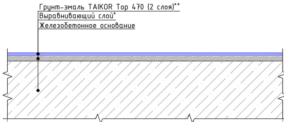
\* Выравнивание поверхности выполнять ремонтными составами на цементной основе.
