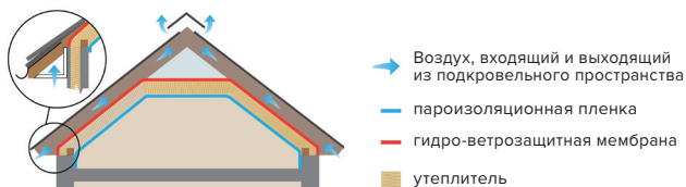
Рис. 3.1. Устройство вентиляции мансарды
