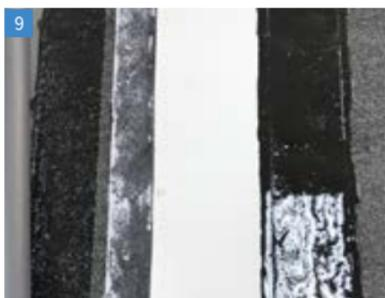
Загерметизированная с битумным гидроизоляционным ковром лента выглядит следующим образом.
