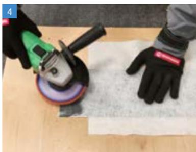
Приклеенный к ленте геотекстиль можно удалить механически с помощью УШМ с лепестковым диском.
