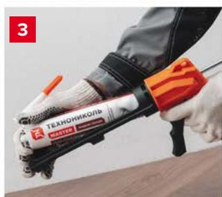
**3** Вставьте картридж с клеем в пистолет. Зафиксируйте его при помощи поршня, не создавая сильного давления.
