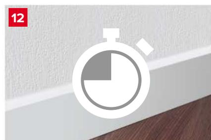
**12** Время схватывания клея — 10–30 минут (в зависимости от продукта). Полную прочность клей наберет через 48 часов.
