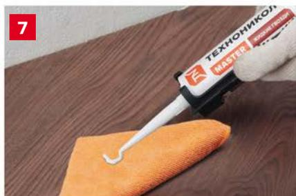
**7** Проверьте работоспособность пистолета, выдавив немного герметика на ветошь.
