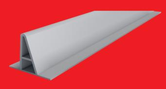
Применение А-профиля помогает сохранить внешний вид фальцевой кровли, сделать ее укладку более технологичной, безопасной и долговечной. Продукт представляет собой отформованное специальном образом изделие с сечением в виде буквы «А», изготовленное из высококачественного кровельного пластика ПВХ (поливинилхлорида). ПВХ устойчив к атмосферному воздействию и ультрафиолетовому излучению.
