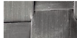
Структура тканого геотекстильного материала
