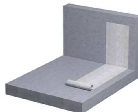
1. Монтаж подстилающего слоя геотекстиля.
