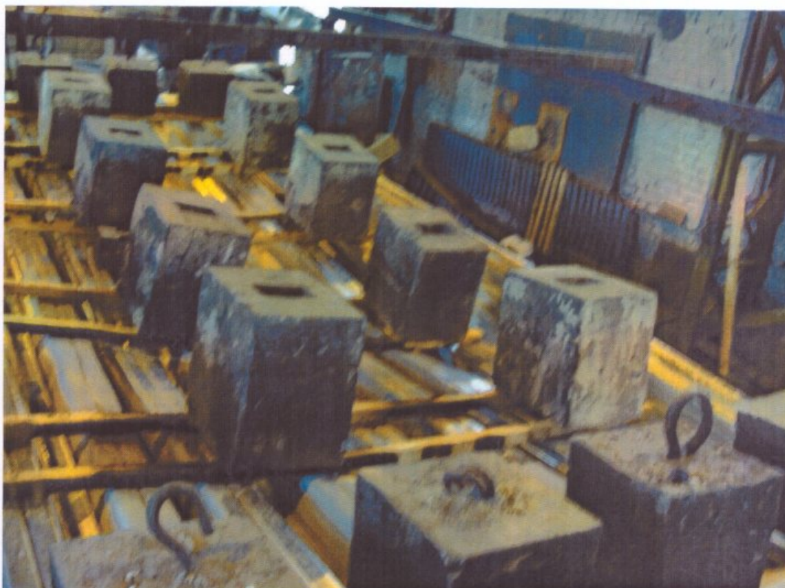
Рис. 4. 40 мин испытания, достижение опытным образцом № 2 предельного состояния по потере несущей способности конструкции (R), вследствие достижения предельного прогиба более 300 мм
