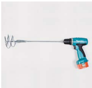
Дрель со специальной насадкой для перемешивания мастики.
