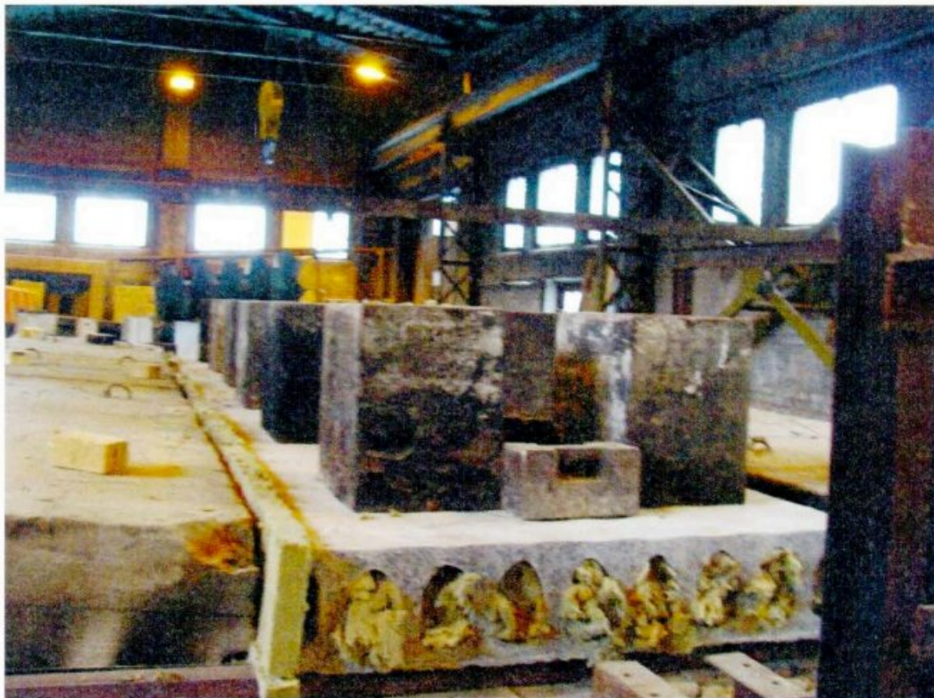
Рис. 3. Опытный образец № 1 с приложенной равномерно-распределенной нагрузкой.
