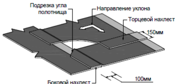
Рис. 5. Нахлесты полотнищ рулонного материала
