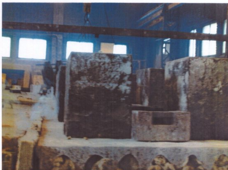
Рис. 7. 185–я мин испытания, окончание огневого воздействия (образец № 2)
