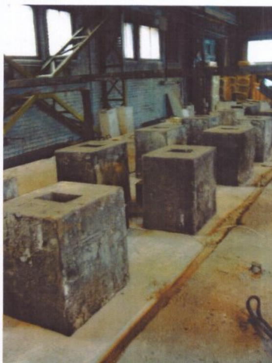
Рис. 3. Опытный образец № 1 с приложенной равномерно-распределенной нагрузкой
