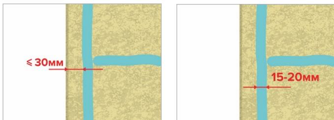
Рис. 8. Правила нанесения клея-пены
