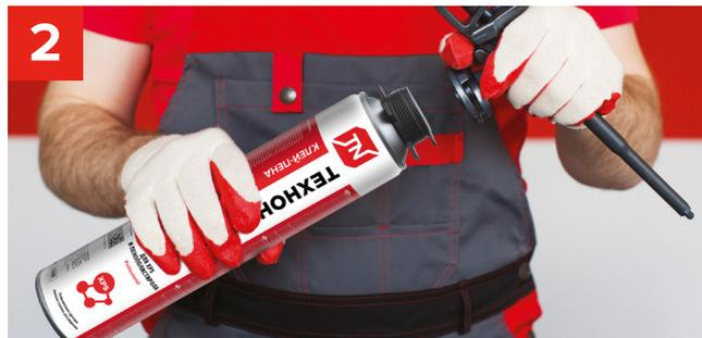
Снять с баллона защитный колпачек, навинтить пистолет на крестообразную насадку с резьбой «крест-кольцо».
