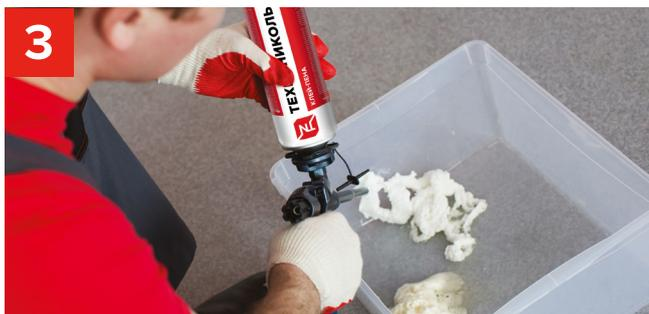
Отвернуть регулировочный винт пистолета, нажать на спусковой крючок, стравив некоторое количество пены.
