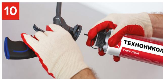
После завершения работ и в случае длительных пауз между работами необходимо тщательно очистить пистолет с помощью очистителя пены.
