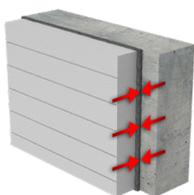
КЛЕЙ-ПЕНА ТЕХНИКОЛЬ для пенополистирола имеет высокую адгезию к бетону, цементным штукатуркам и другим минеральным основаниям
