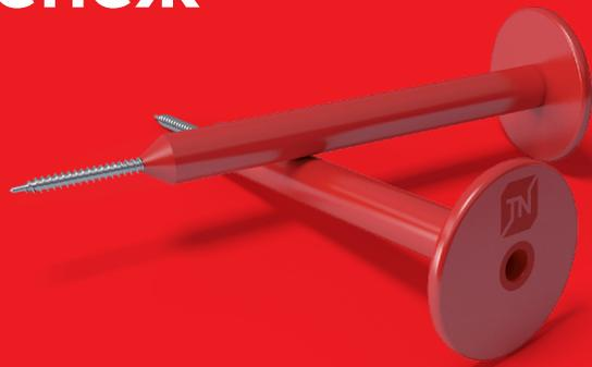
Изготавливается из высококачественного стабилизированного полимерного материала повышенной прочности и морозостойкости. Выпускается длиной от 20 до 350 мм. Длина телескопического элемента подбирается исходя из толщины слоя теплоизоляции и должна быть меньше толщины слоя теплоизоляции не менее чем на 20 мм.
