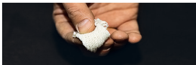
Рис. 3.8. Определение высыхания праймера
