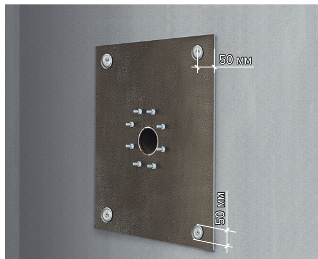
Рис. 5.3. Механическая фиксация слоя усиления в месте перехода с вертикальной на горизонтальную поверхность и трубной проходки
