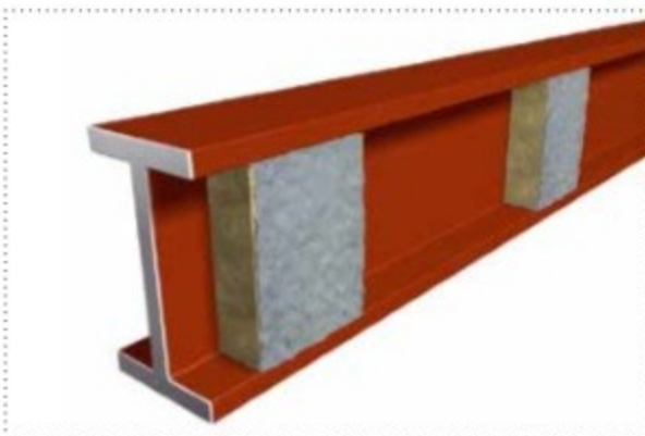
4. Монтаж дополнительных монтажных элементов (вставок)
